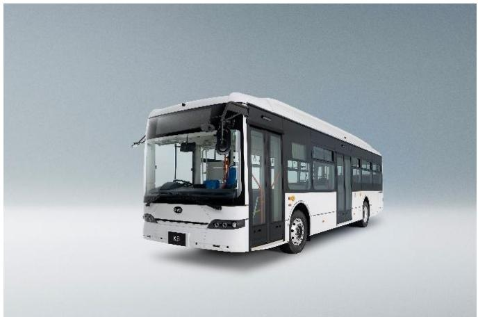
大型EVバスならではの広々とした車内空間と高い輸送力を実現。独自の薄型、大容量ブレードバッテリーにより、フルフラットの快適な車内レイアウトと、長距離の路線バスにも対応する航続距離を両立。乗客に快適な移動を提供し、地域の公共交通を支えます。
